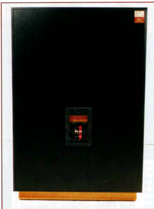
Sul retro solo una morsettiere per il cablaggio di potenza. (Comunque doppia per il biwiring)
